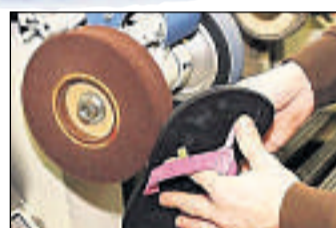
Die Sohle der fertigen Sandale wird fußgerecht abgerundet.
