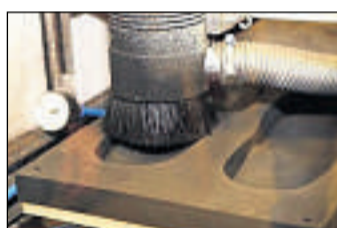
Die Schuhbasis wird automatisch ausgefräst und poliert.
